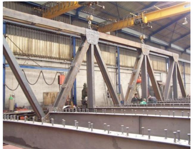
d'entretoises en poutre reconstituées soudées, dont l'âme est profilée afin d'assurer le profilage de la dalle pour l'écoulement naturel des eaux vers les côtés de la chaussée. La liaison acier-dalle est assurée par des goujons connecteurs. Des panneaux de coffrage sont
