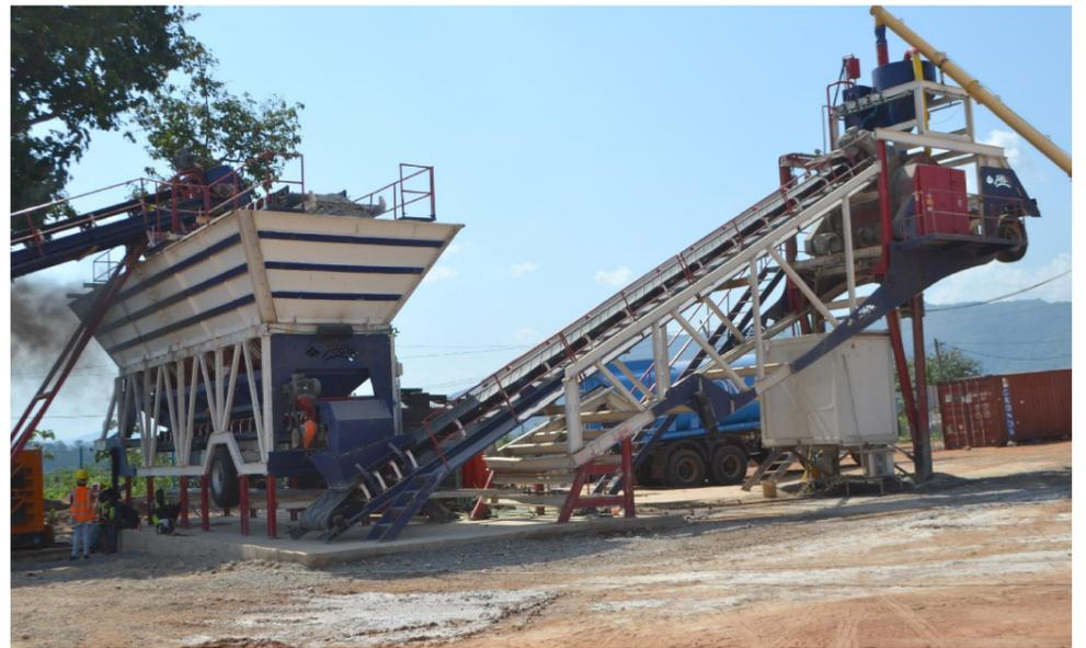
Une centrale à béton de la base vie Togo Grain
