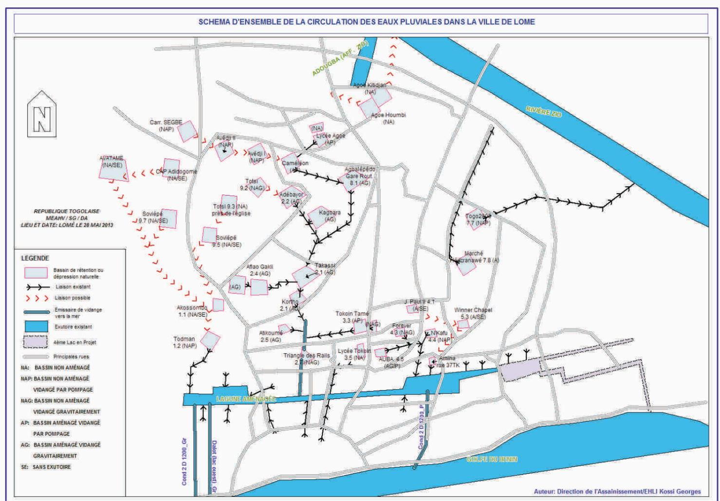
propositions d'aménagement de 24 bassins de rétention (BR) pour un volume total de 1,35 million de mètres cubes d'eau à stocker, de construction de canaux de différents types, dont 30 km de canaux primaires sous formes de conduites de gros diamètres, de dalots et de caniveaux à ciel ouvert.
