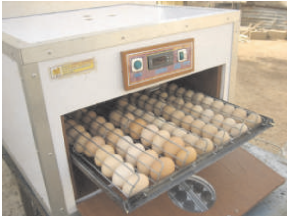
Une couveuse numérique avec régulation
