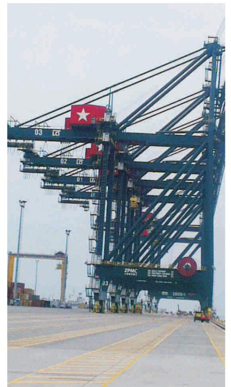
sous régionale. S'agissant du 3e quai, il permet d'accueillir des navires portes conteneurs d'au moins 7.000 EVP. Il est équipé de portiques de quai et de grues RTG, puis dispose d'une surface d'entreposage de 38 hectares pour la manutention et l'entreposage d'un volume annuel de 1,5 million de conteneurs.
